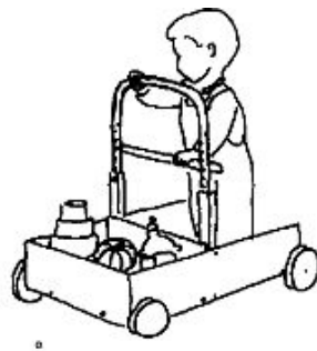
Рис. 21.5. Прочные предметы, которые использованы в качестве ходунков: а – большой деревянный ящик – хорошая опора для ходьбы по дому. Ящик очень устойчив, что обеспечивает противодействие – это помогает ребенку с гиперкинетической формой церебрального паралича опираться на него. Для того чтобы ходить по коврам, к ящику можно приделать деревянные полозья; б – низкая тележка. Размеры: длина 50 см, ширина 35 см, высота 55 см.
